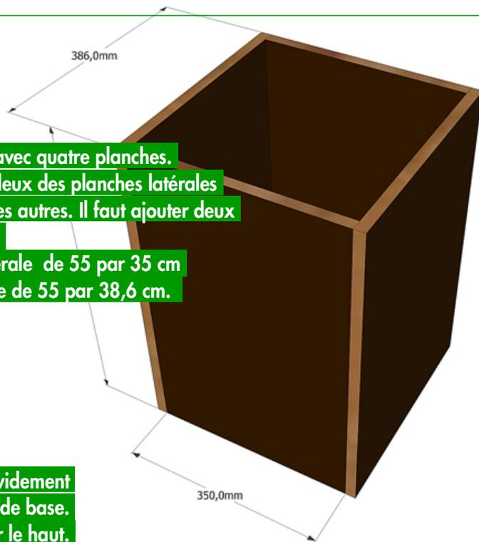
Réalisez le coffrage complet avec quatre planches.
