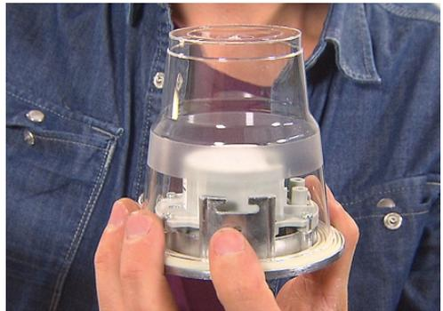
Il est facile de construire des formes droites. Pour les détails et les formes rondes, vous pouvez utiliser des objets existants. Après quelques recherches, nous avons trouvé un gobelet en plastique dans lequel notre luminaire se glisse parfaitement. Nous l'avons donc collé à l'endroit où arrivera le luminaire.
