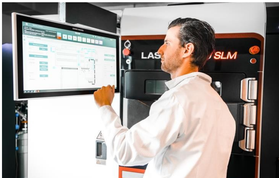
Melotte begon in 2007 als een van de eersten in de Benelux met 3D-metaalprinten. Het investeerde in SLM-technologie (selective laser melting)
