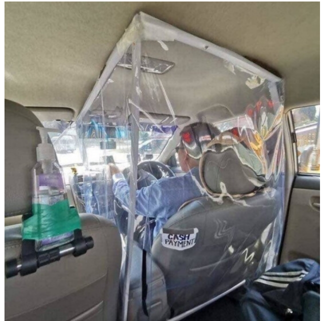
Soepele transparante gordijnen : onvoldoende opgespannen en vervorming van het gezichtsveld/indirect zicht.
