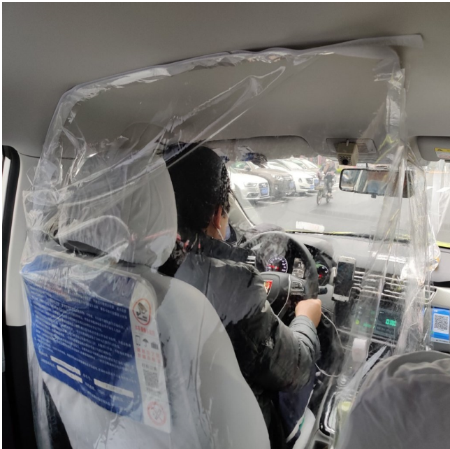
Soepele transparante gordijnen : onvoldoende opgespannen en vervorming van het gezichtsveld/indirect zicht.
