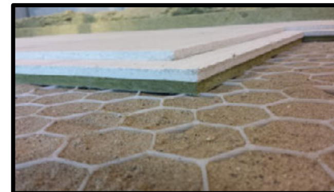
+ 4 cm zand in grid + Rigidur E30 MW 60(-5;-14)
